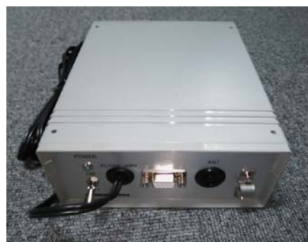
アンテナ用パワーユニット
